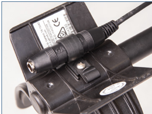
4. Вставьте адаптер для наушников в пластиковый зажим
