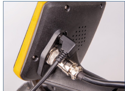
5. Подключите адаптер к разъему для наушников 1/8 дюйма на задней панели блока управления
