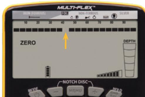
Utilice los botones de NOTCH DISC para posicionar el cursor de identificación de objetivo por encima del píxel que desea eliminar (vea la ilustración de la izquierda). Utilice el botón (✓/x) para eliminar este píxel de la escala inferior (ver a continuación). Este objeto ahora se rechaza.
