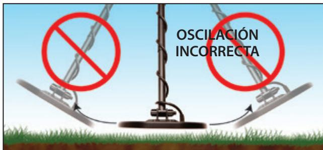
Haga oscilar la bobina de búsqueda paralela a las líneas de arado y a la orilla del agua. Esto minimizará los efectos negativos provocados por suelos desiguales en campos arados y diferentes cantidades de humedad cerca del agua. No haga oscilar la bobina de búsqueda perpendicular a las líneas de arado y a la orilla del agua, ya que podría generar cambios inesperados en la respuesta del suelo y reducir el desempeño del detector.
