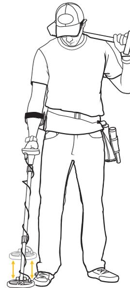
tres problemas: el detector ya está lo suficientemente nivelado; el suelo actual muestra una mineralización tan neutra que las configuraciones no cambiarán; o bien, hay un objeto de metal debajo de la bobina que evita que el detector logre el balance de suelo.
