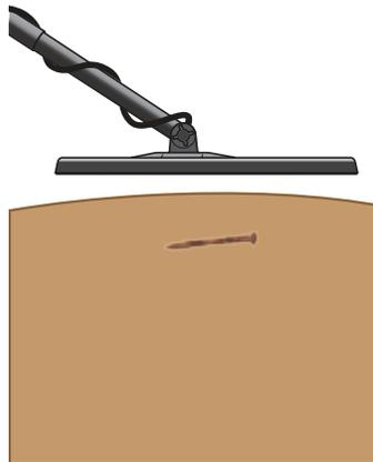
En esta ilustración, el Apex está funcionando en modo Zero (Cero) con dos píxeles de hierro eliminados. Este clavo se encuentra entre 18 y 24 en la escala de identificación de objetivo digital. Para eliminar el clavo de la detección, quite tres píxeles más de hierro.
